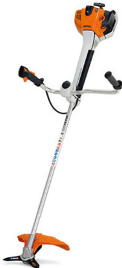
Parfaite pour exécuter des travaux de fauchage et de nettoyage délicat. C'est la machine référence chez les professionnels des espaces verts. Système anti vibration à 4 Points, démarrage ErgoStart, réglage du guidon sans outil, moteur 2 temps à balayage stratifié. Harnais haut de gamme inclus (Advance Universel PLUS).
