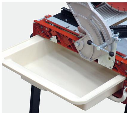
Bac à eau en polypropylène, démontable pour faciliter le nettoyage, capacité 38 litres. Refroidissement du disque par pompe.
