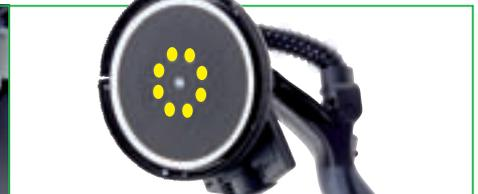
L'aspiration intérieure est assurée par le système à 8 trous. Il retient les poussières fines, tout en assurant l'effet ventouse de la PLANEX sur les cloisons et les plafonds. La puissance de l'effet ventouse se règle grâce à la molette spéciale d'aspiration.
