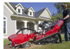
Dessoucheuse hydraulique Barreto - 31CV
