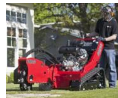
Dessoucheuse hydraulique Barreto - 31CV
